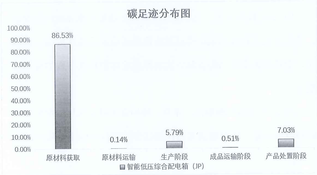
图 5.2.1.2 智能低压综合配电箱（JP）生命周期阶段碳排放分布图
