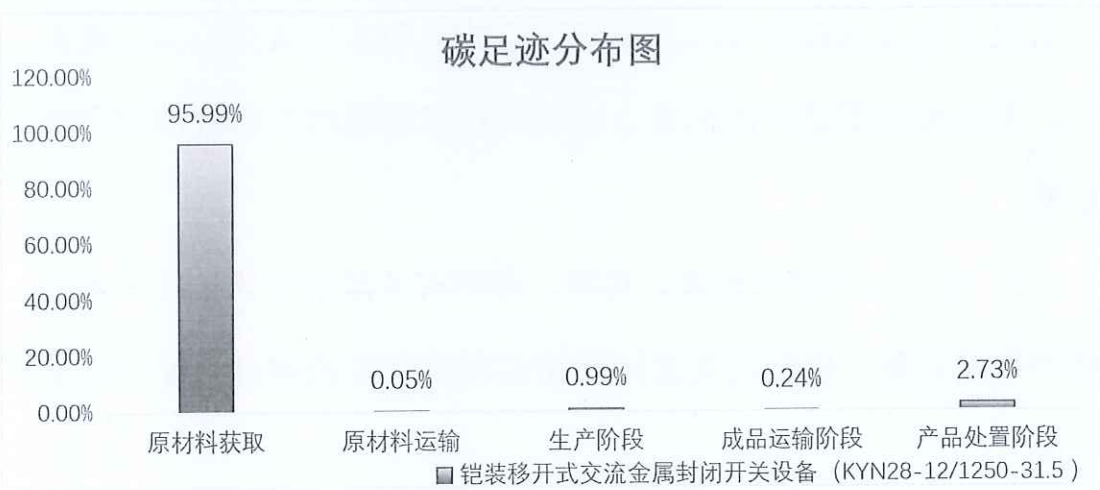
图 5.2.1.2 铠装移开式交流金属封闭开关设备（KYN28-12/1250-31.5）生命周期阶段碳排放分布图
