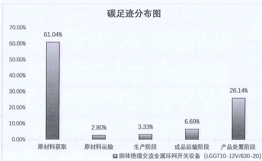
图 5.2.1.2 固体绝缘交流金属环网开关设备 (LGGT10-12V/630-20) 生命周期阶段碳排放分布图
