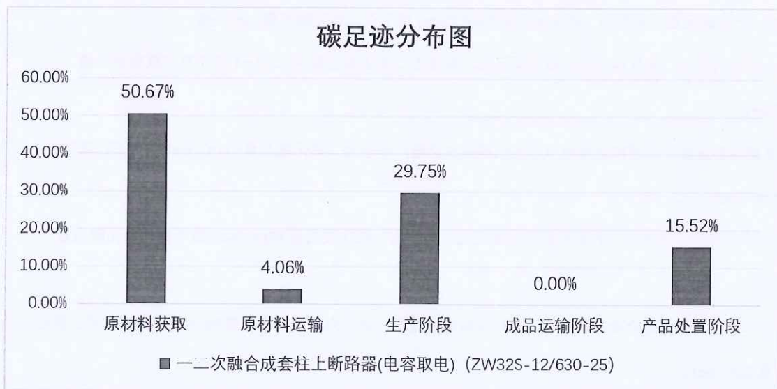
图 5.2.1.2 一二次融合成套柱上断路器(电容取电) (ZW32S-12/630-25) 生命周期阶段碳排放分布图
