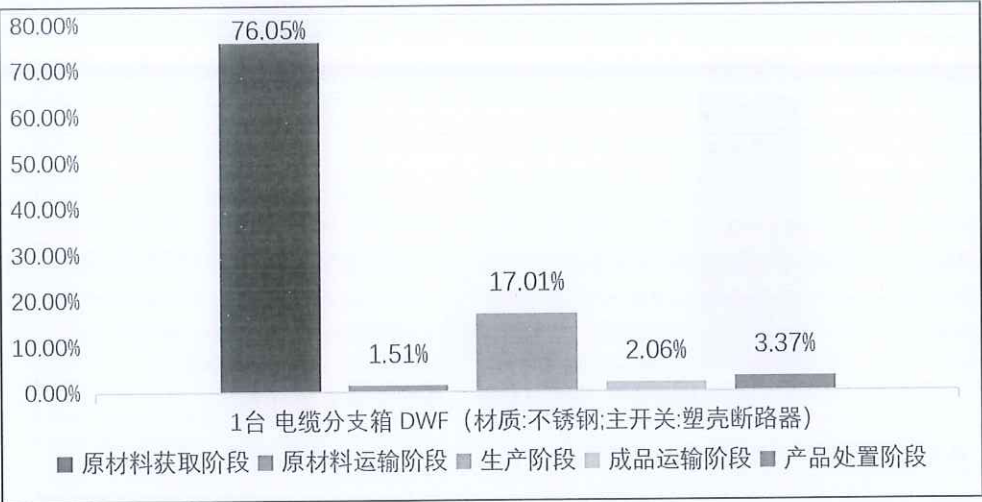
图 5.2-2-1 1 台 电缆分支箱 DWF（材质:不锈钢;主开关:塑壳断路器） 生命周期阶段碳排放分布图
