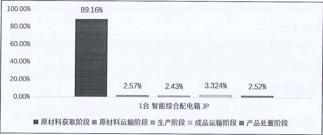
图 5.2-2-1 1 台 智能综合配电箱 JP 生命周期阶段碳排放分布图
