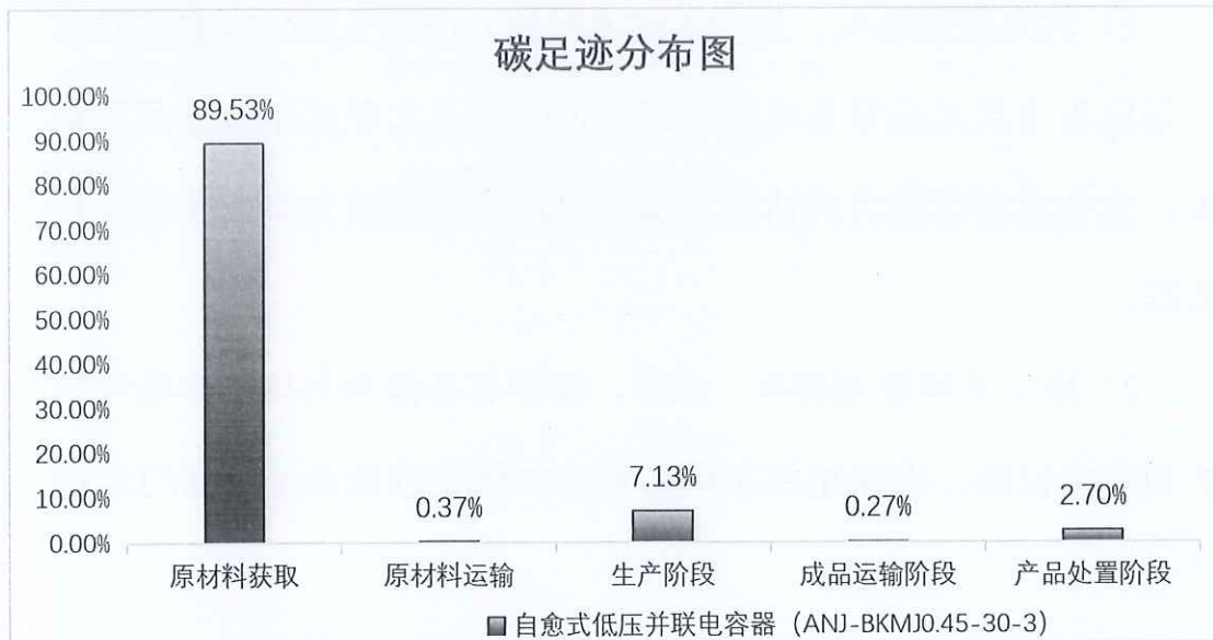
图 5.2.1.2 自愈式低压并联电容器 (ANJ-BKMJ0.45-30-3) 生命周期阶段碳排放分布图
