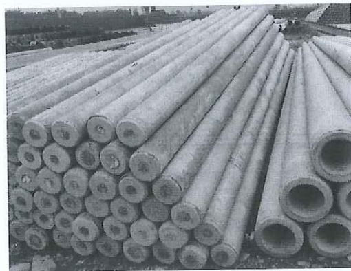
环形混凝土电杆 Z \Phi 190 \times 12 \times M \times G ; 环形混凝土电杆 Z \Phi 190 \times 15 \times M \times G
