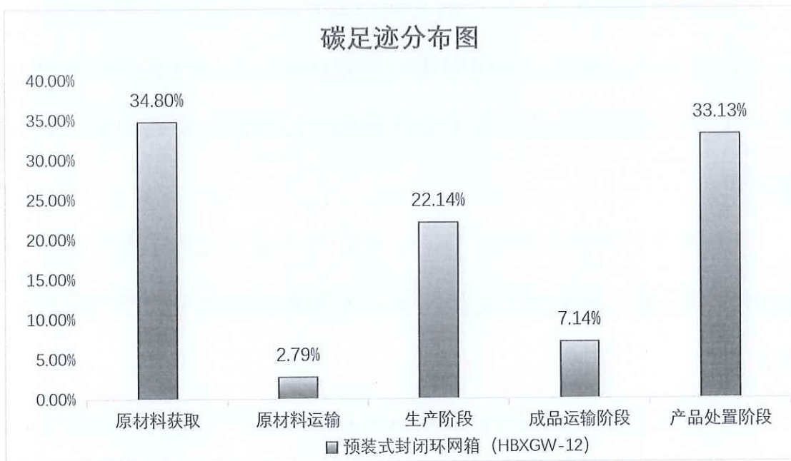
图 5.2.1.2 预装式封闭环网箱 (HBXGW-12) 生命周期阶段碳排放分布图
