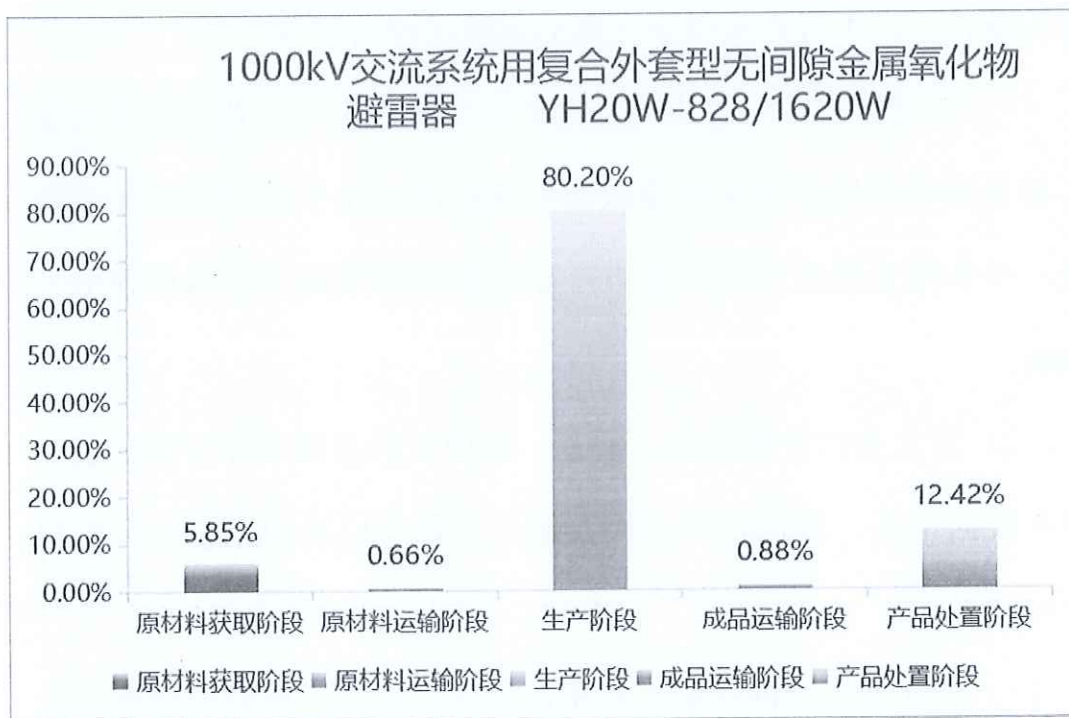
图 5.2.2 1000kV 交流系统用复合外套型无间隙金属氧化物避雷器 YH20W-828/1620W（生 命周期阶段碳排放分布图
