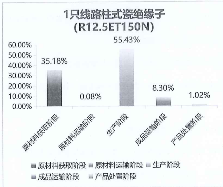
图 5.2-2 一只线路柱式瓷绝缘子 R12.5ET150N
