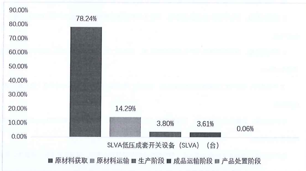
图 5.2.1-2 SLVA 低压成套开关设备（SLVA）生命周期阶段碳排放分布图
