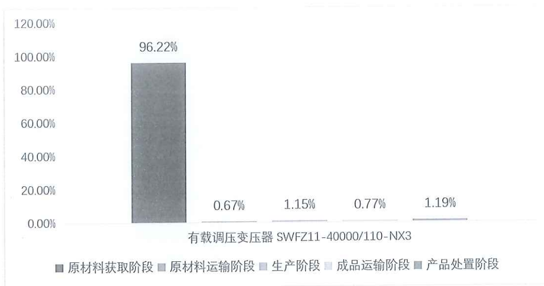
图 5.2-2 有载调压变压器 SWFZ11-40000/110-NX3 生命周期阶段碳排放分布图
