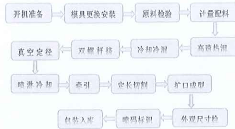
高密度聚乙烯(HDPE)管材 (DN200*12mm) 生产工艺流程图:
