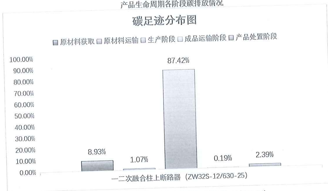
图 5.2-2 1 台一二次融合柱上断路器（ZW32S-12/630-25） 产品生命周期阶段碳排放分布图
