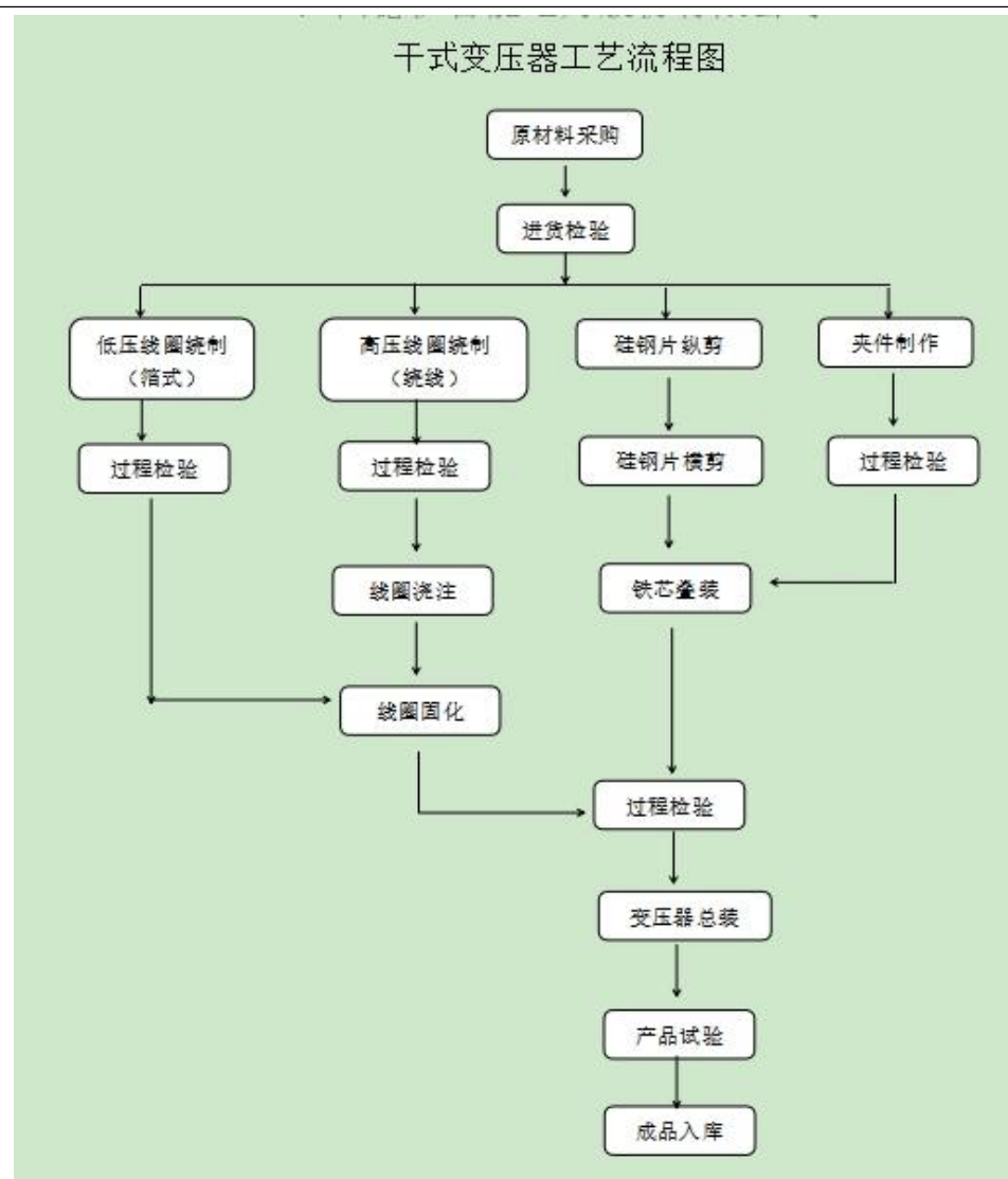
干式变压器工艺流程图
