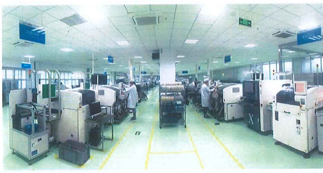
图 1-4 防静电及防尘生产车间
