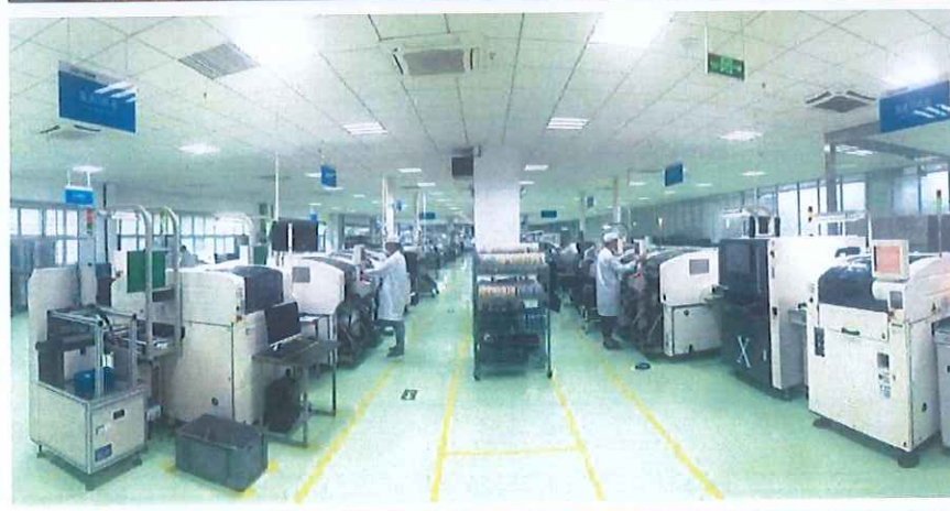
图 1-4 防静电及防尘生产车间
