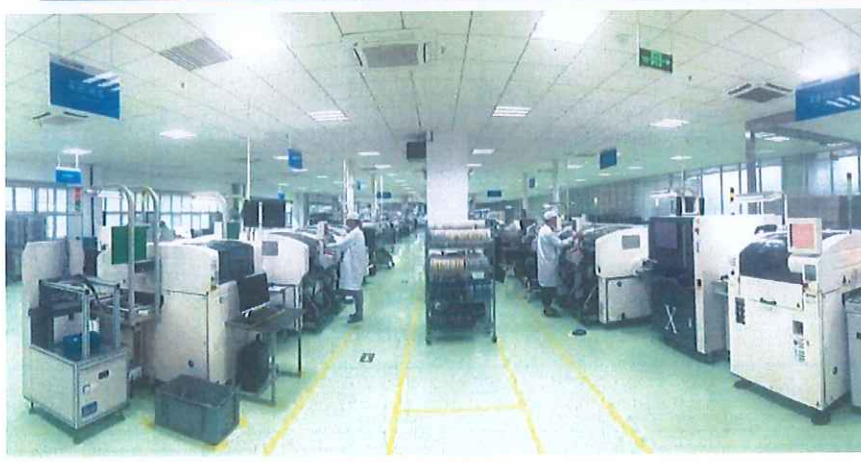
图 1-4 防静电及防尘生产车间
