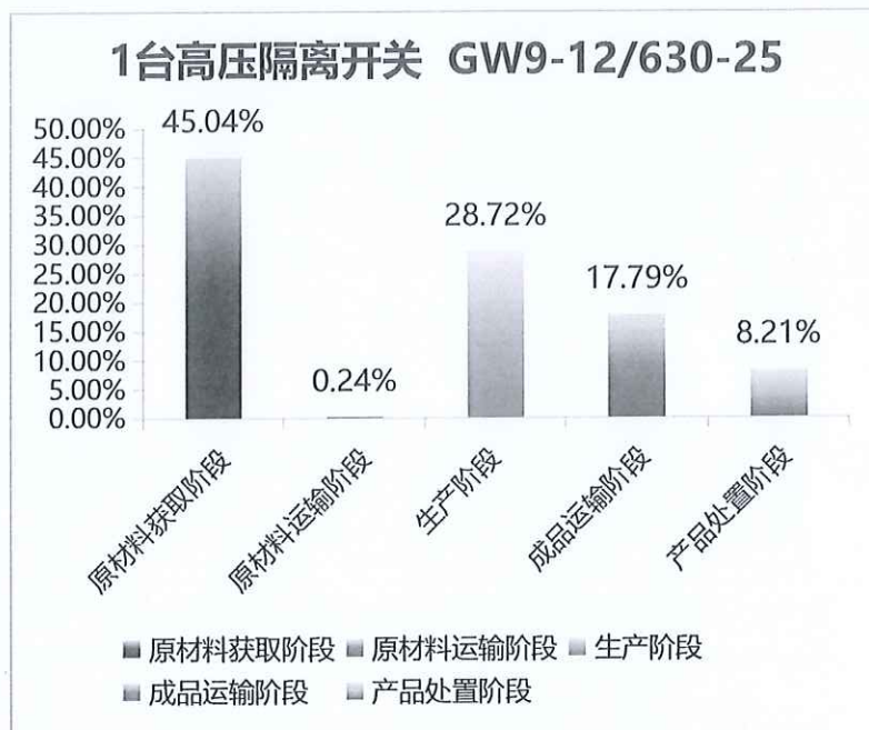
图 5.2-2 一台高压隔离开关（GW9-12/630-25）生命周期阶段碳排放分布图
