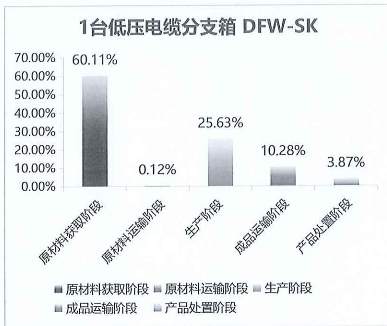
图 5.2-2 一台低压电缆分支箱（DFW-SK）生命周期阶段碳排放分布图
