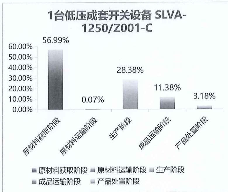
图 5.2-2 一台低压成套开关设备 (SLVA-1250/Z001-C) 生命周期阶段碳排放分布图
