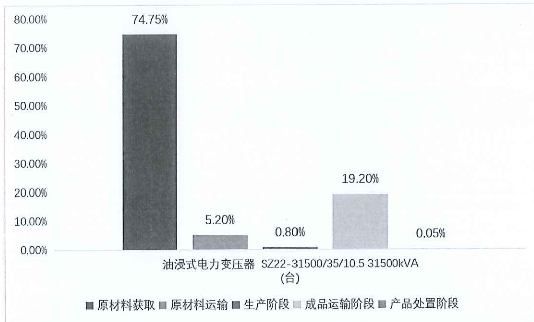
图 5.2.2 油浸式电力变压器（SZ22-31500/35/10.5 31500kVA）生命周期阶段碳排放分布图
