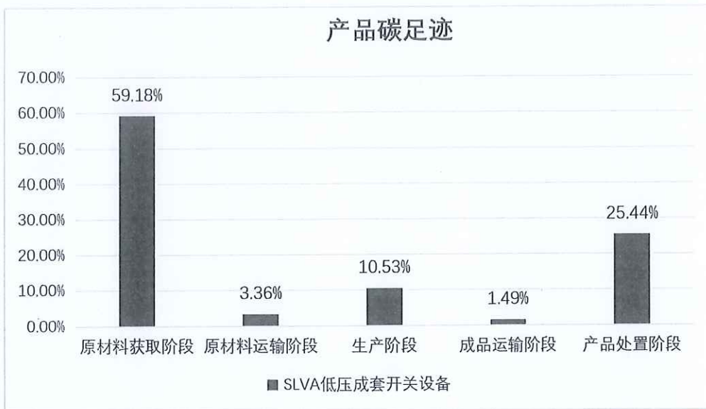
图 5.2.2 SLVA 低压成套开关设备 (SLVA-2500/Z001-C) 生命周期阶段碳排放分布图
