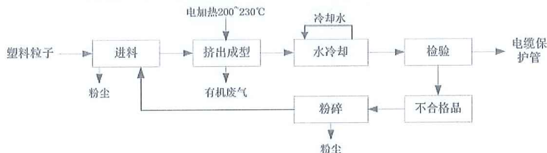
图 5-1 电缆保护管生产工艺流程图示意图
