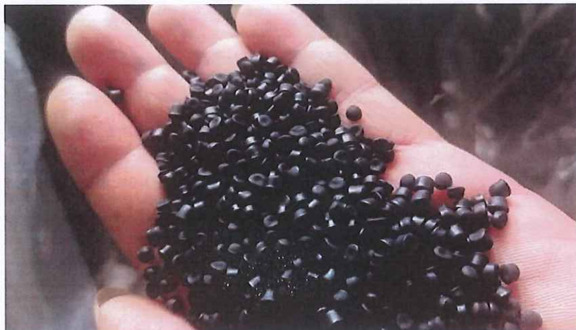
图 6-2 10kV 交联聚乙烯绝缘电缆导体用氧化物交联型半导体屏蔽料
