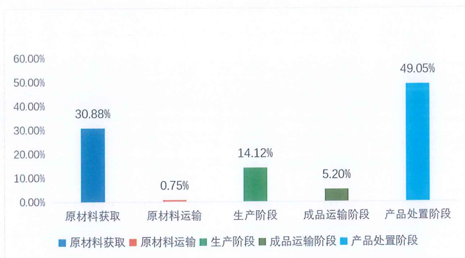
图 5.2.7-2 密集型母线槽（BMC9 6300A~400A）生命周期阶段碳排放分布图
