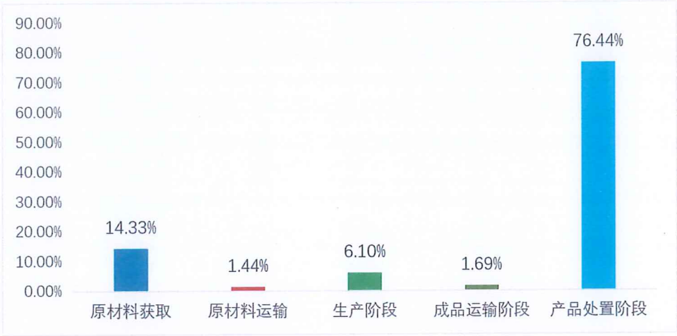
图 5.2.6-2 密集型母线槽（BMC10 6300A~400A）生命周期阶段碳排放分布图
