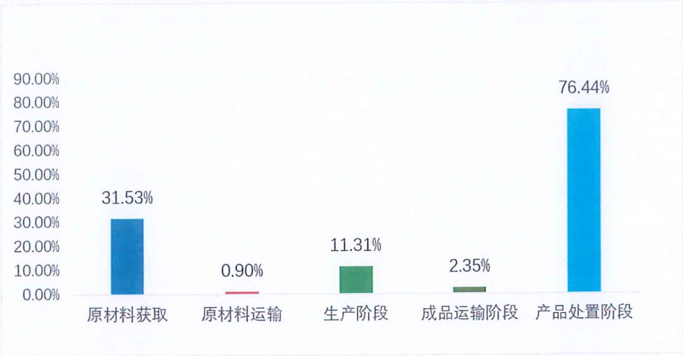
图 5.2.5-2 卧式母线系统（IHBS-D 1600A~250A）生命周期阶段碳排放分布图
