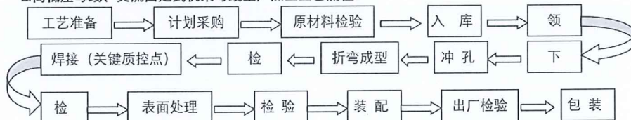
2. 高低压母线、交流固定式机架母线生产加工工艺流程：
