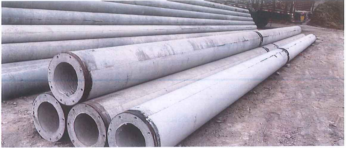
锥形水泥杆-类型:部分预应力,杆型:法兰组装杆,杆长 m:15m,梢径 mm:430mm,强度等级:U2
