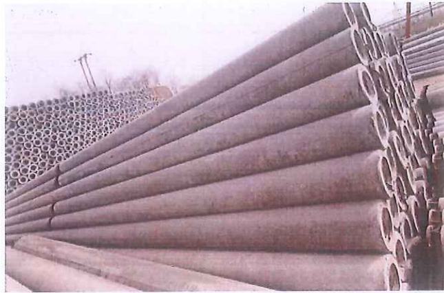
锥形水泥杆:非预应力, 杆型: 法兰组装杆, 杆长 m:12m, 梢径 mm:190mm, 强度等级:M
