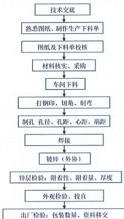
铁附件生产工艺流程图
